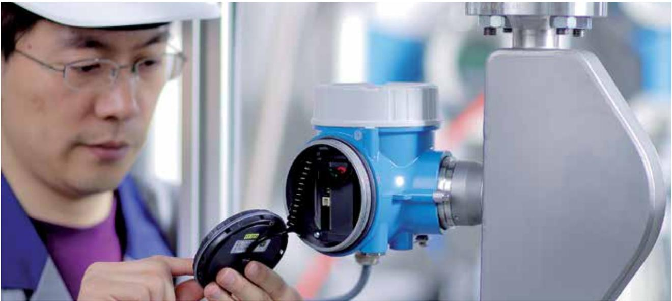
Le processus de vérification ne prend en général que quelques minutes et peut être activé par l'afficheur, par FieldCare ou par un serveur Web (s'il est intégré).
