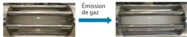
Fig. 10 : Test d'émission de gaz de Promass Q avec MFT au laboratoire DNV GL.
